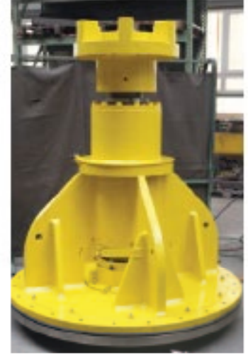
Genel revizyondan geçmiş kağıt makinesi yatağı Escher Wyss ST11
