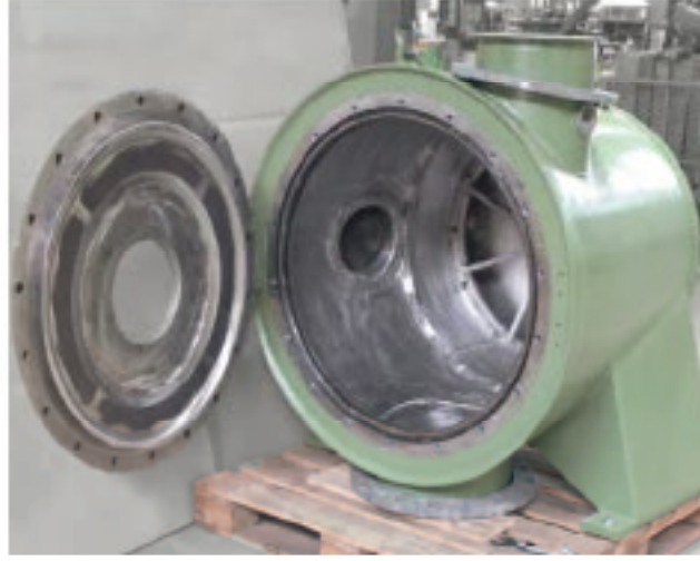
CNC tezgahında işlenerek tamamlanmış aşınmaya dayanıklı rejenere edilmiş Fiberizer gövdesi F1T
