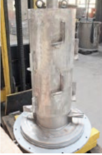
Tambur rotoru C512 (başlık sayfasına bakın) aşınmaya dayanıklı şekilde revize edilmiş
