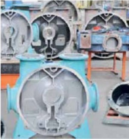
İlgili kullanım koşulların uyarlanmış kompozit malzemeyle kaplanmış yan levhalar
