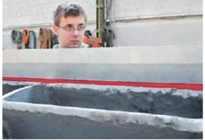
Kuılmamadan sonra aşınmış Siemens-Elmo vakum pompası rotoru, rotorun malzeme kaybı kırmızı işaretlenmiş.
