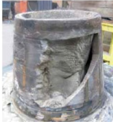
Tıkanmış Nash konisi, yerinde yapılan analiz %85'lik bir kapasite kaybı olduğunu gösterdi
