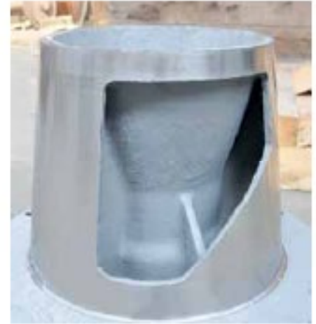
Temizlenen ve kompozit malzemeyle yeniden kurum bağlamaya karşı kaplanan Nash konisi
