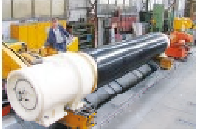
Rolls II fabrikasında genel revizyondan geçen bir emiş silindirin taşlanması
