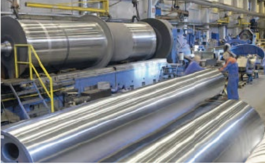
Finlandiya'daki Karhula fabrikasında bulunan büyük silindir tomahanesi, maks. parça büyüklükleri Ø 2,10 m x 18 m boy (80 ton)
