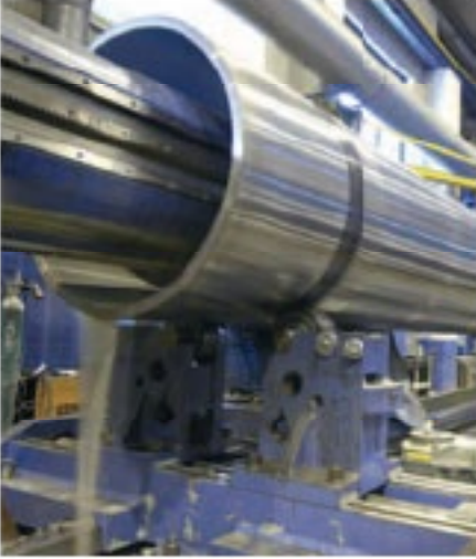
Yeni bir dengeleme silindir mantosunu üretmek için bir borunun delinmesi
