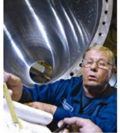
Servis hizmeti olarak honlanan Nipco silindir mantosu, yüzey pürüzlülüğü Ra = 0,4 µ
