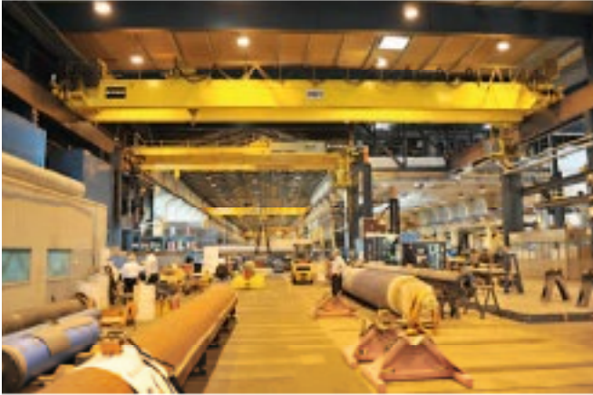
Üretim dört salon bordasından oluşuyor. Her borda üretim bakımından belirli silindir tipleri ve silindir büyüklükleri için optimize edilmiştir.
