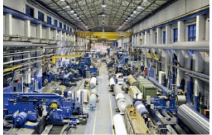
Torna, taşlama, boru delme, honlama ve balans alma gibi büyük silindir işleme için salon bordası. Burada 80 tona kadar ağırlıklar mümkündür.
