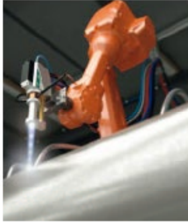
HVOF yöntemiyle bir merdanenin tungsten karbür kaplaması
