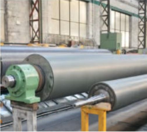
Bir karton makinesinin ıslak partisinden seramik, kaplı elek tahrik silindiri ve elek iletim silindiri
