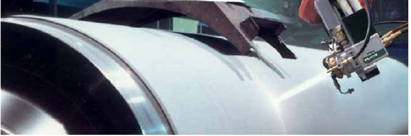
Plazma yöntemiyle bir merkezi silindirin RiWaMat seramik kaplaması
