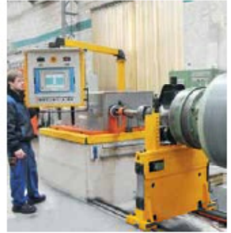
Balans tezgahında bulunan plazma seramikli merkez silindiri
