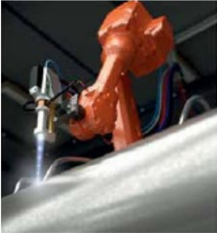
HVOF yöntemiyle bir calander silindirinin RiWaMat tungsten karbür kaplaması
