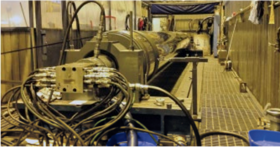
Her türlü bükme dengeleme silindirlerini ve emme silindirlerini test etmek için Karhula test tezgahı
