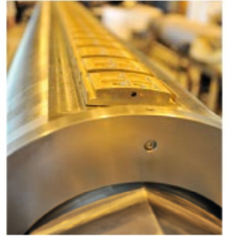
Bir Sym silindirinin elden geçirilmiş boyunduruğu
