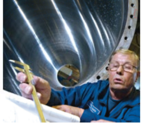
Servis olarak – yeniden bilenmiş Nipco silindir kabuğu, yüzey pürüzlülüğü Ra = 0,4µ
